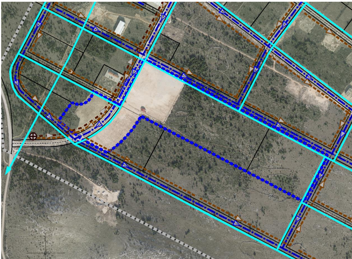
izvadak iz kartografskog prikaza 2.2. Vodoopskrba i odvodnja - ID UPU gospodarske zone Podi
